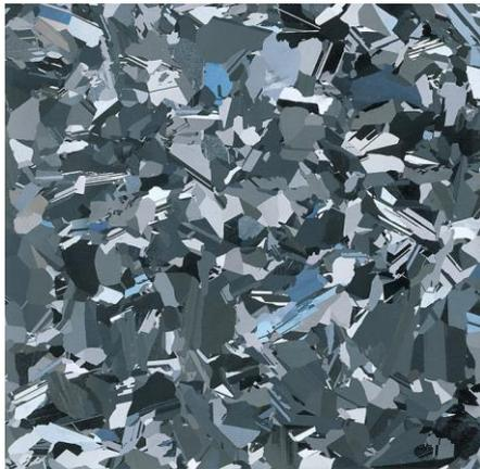
Polykristalliner Wafer für Solarzelle
